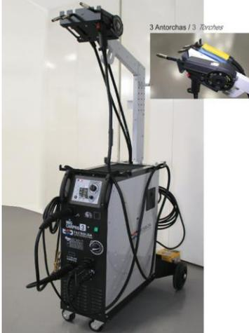
MIG-MAG trifásico con 3 conectores de antorcha. Soldadura de acero, acero inox, aluminio y acero de alta resistencia.
