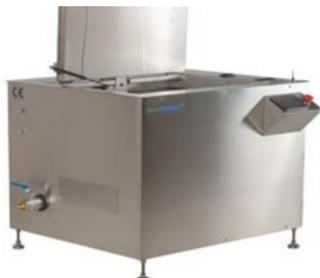
Lavadora de piezas por ultrasonidos. La pieza a lavar se sumerge en agua junto con el detergente de lavado. El lavado se realiza gracias a la potencia de ultrasonidos y el detergente de lavado. Equipada con una pantalla táctil de 10" se pueden realizar todas las operaciones de la máquina. La plataforma de inmersión es manual, las piezas deben ser introducidas por el operario en la cuba de lavado. Todos los modelos están equipados con filtro de recirculación.
