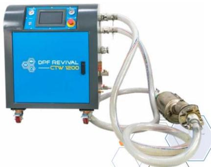
Lavadora universal para filtros de partículas de turismos, vehículos comerciales ligeros y camiones. Dispone de 3 modos de lavado, tanque de 120 litros y calentamiento del líquido de limpieza. Se puede utilizar sin desmontar el filtro de partículas del vehículo solamente desconectándolo y conectando la máquina. Equipada con una válvula para la liberación de presión en filtros muy saturados, evitando desplazamiento de cerámicas
