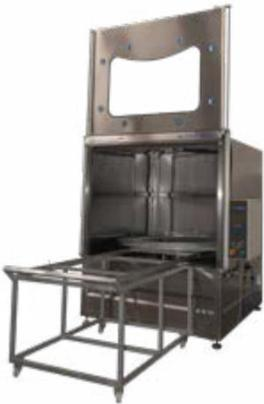
Lavadora de piezas automática. El lavado se realiza automáticamente mediante diversos chorros superiores, inferiores y laterales a través de los dos circuitos de lavado. Cuadro de control electromecánico con termostato digital para configurar tanto la temperatura, como el tiempo del tratamiento. Todos los modelos están equipados con una electroválvula para el llenado automático de los depósito, un extractor de vapores, bloqueo retardado en la apertura de la puerta y un disco separador de aceite.
