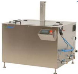
Lavadora de piezas por ultrasonidos. La pieza a lavar se sumerge en agua junto con el detergente de lavado. El lavado se realiza gracias a la potencia de ultrasonidos y el detergente de lavado. Equipada con una pantalla táctil de 10" se pueden realizar todas las operaciones de la máquina. La plataforma de inmersión es de accionamiento neumático y, tanto el pistón como la parrilla, están reforzados para soportar la capacidad de carga.
