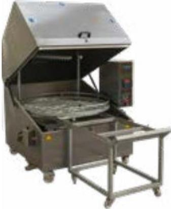
Lavadora de piezas automática. El lavado se realiza automáticamente mediante chorros superiores, inferiores y laterales a través de los dos circuitos de lavado. Cuadro de control electromecánico con termostato digital para configurar tanto la temperatura como el tiempo del tratamiento. Todos los modelos están equipados con una electroválvula para el llenado automático del depósito y disco un separador de aceite.
