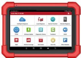
Equipo de diagnóstico profesional desarrollado con SO Android 10.0. Diseño ergonómico con funda de goma con cuatro cantos reforzados para prevenir daños por colisión. Compatible con los nuevos protocolos CAN FD Soporta diferentes accesorios como; osciloscopio, simulador de sensores, comprobador de batería, endoscopio e impresora WiFi
