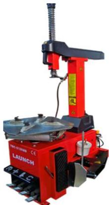
Desmontadoras automáticas con brazo horizontal telescópico y destalonador de gran potencia. Incluyen un cabezal para el desmontaje de acero y otro de plástico de alta resistencia para llantas de aluminio, junto con un manómetro de presión para el inflado del neumático. Plato con diámetro exterior de 14-24" e interior 12-22".
